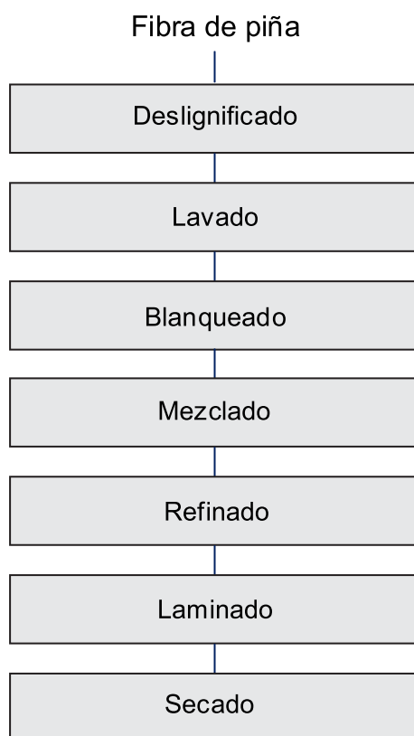
Figura 2. Operaciones para la obtención del material base de los residuos de las fibras de hoja de piña para cuero vegetal.
