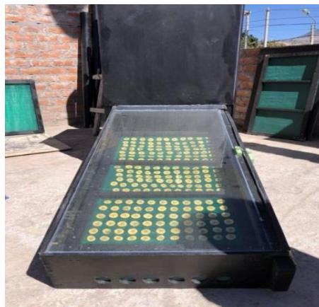
Fig.2. Secador solar Mixto construido en funcionamiento.
