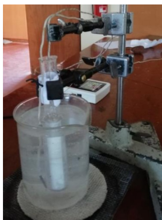
Figura 5. Arreglo experimental y la Curva de calentamiento de la parafina de 11.18 g, para determinar la temperatura de fusión de la muestra.
