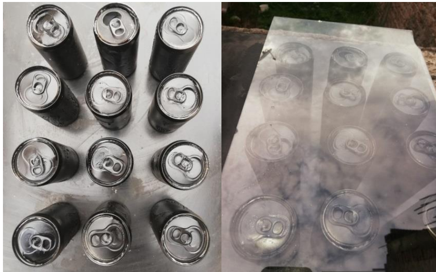
Figura 10. Acumulador solar térmico con PCM (Parafina), doce unidades e instalada en el colector del secador.
