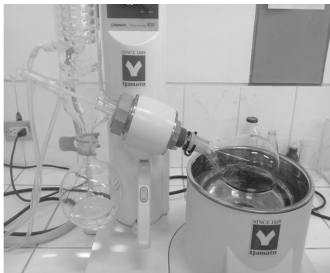
Figura 2. Muestra de extracto hidroalcohólico de Colletia spinosissima Gmelin "tacsana". Sometida a Rota evaporador para eliminar residuos de alcohol.
