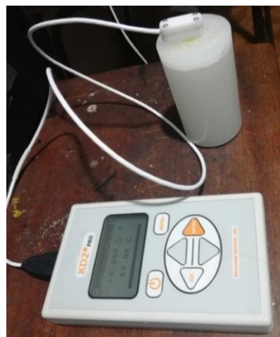
Fig.4 Medida de la conductividad térmica de una muestra de parafina y al lado derecho la distribución de estas unidades del sistema de acumulación térmica: vista superior.
