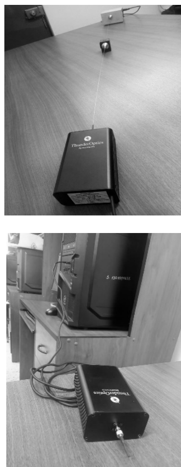
Fig. 6. Conexión de las fibras de la fuente a la muestra y al espectrómetro.
