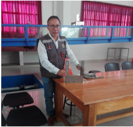
Figura 2. Vertedero rectangular con contracción
