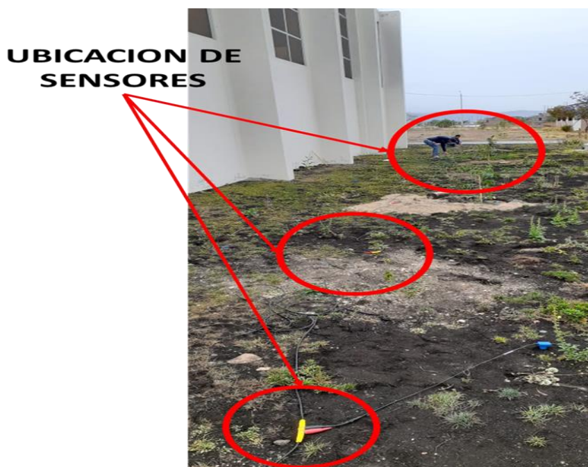
Figura 5. Proceso de calibración del equipo de refracción sísmica y estimulación de la fuente con presencia del colaborador de la investigación
