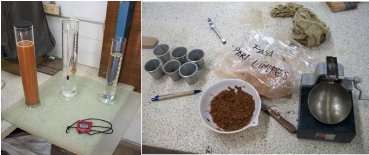
Figura 2. Ensayo de higrómetro (izquierda) y ensayo de Casagrande (derecha).
