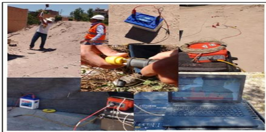
Figura 10. Equipos debidamente conectados y el registro de datos en la PC.
