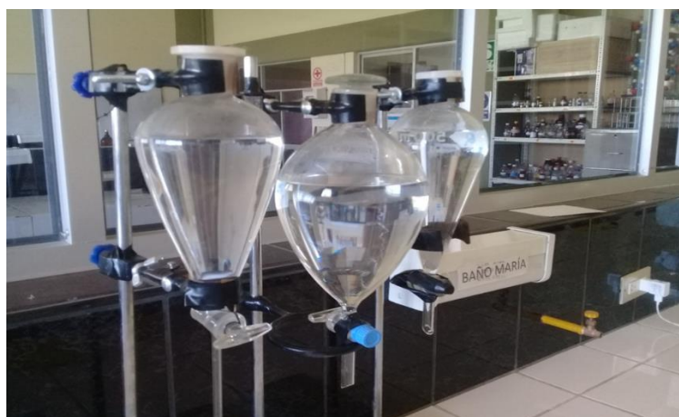
Fig. 1 Método de separación de la fracción de aceite esencial del extracto acuoso de Colletia spinosissima Gmelin “tacsana”
