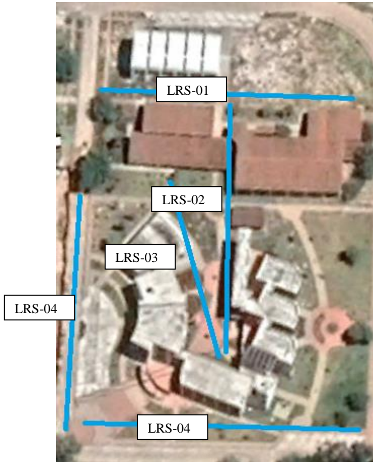
Figura 7. Ubicación de las líneas de tendido sísmico (LRS) para el ensayo correspondiente.
