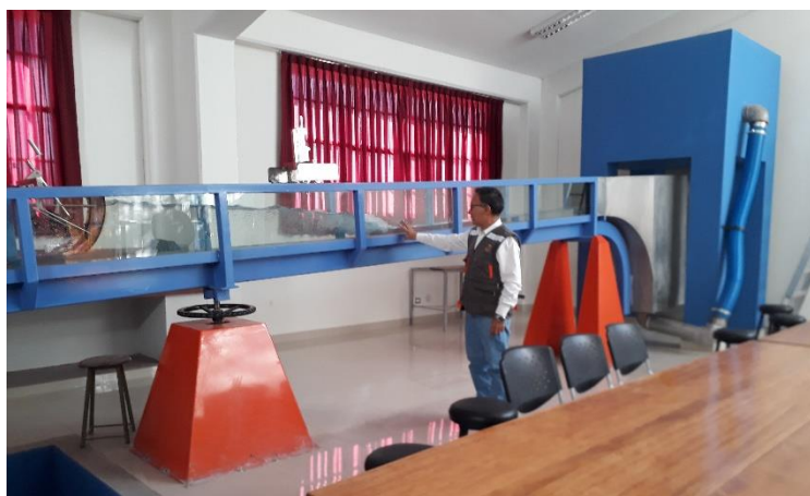
Figura 1: Canal de pendiente variable de sección rectangular
