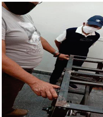
Figura 1 . En la prueba inicial la mesa concentradora tenía un movimiento vertical
