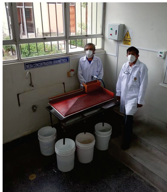
Figuras 9, 10. Mesa concentradora gravimétrica modificada e instalada en el Laboratorio de Metalurgia de la UNSCH.
