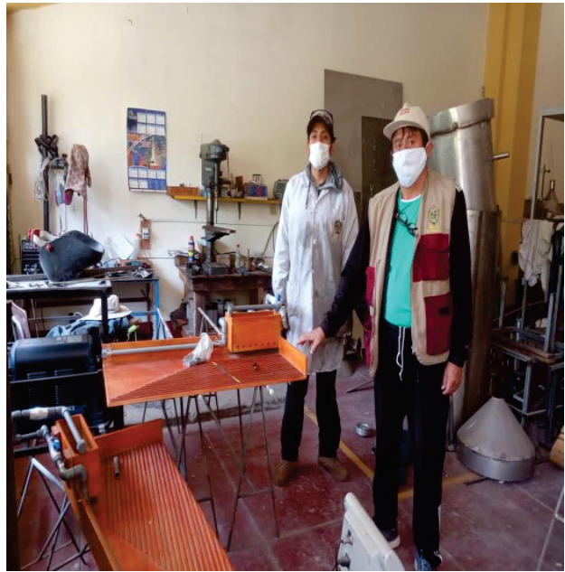
Figura 2. Equipo a ser modificado: (a) izquierda, estructura de la mesa gravimétrica; (b) derecha, tablero superior.
