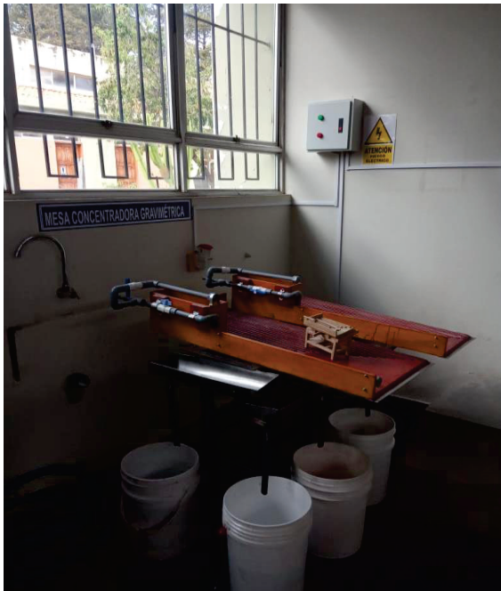
Figuras 9, 10. Mesa concentradora gravimétrica modificada e instalada en el Laboratorio de Metalurgia de la UNSCH.
