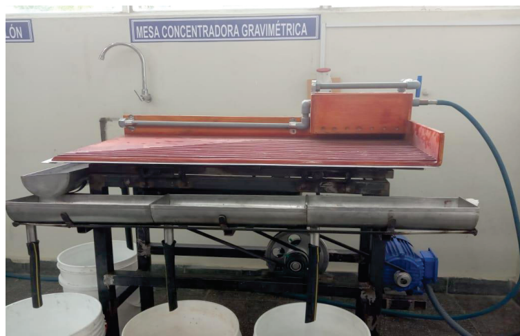
Figura 11 - Mesa concentradora gravimétrica en el cual se observa: el soporte de la mesa, la polea, el brazo excéntrico, la platina de refuerzo del tablero, la faja, el motor, las artesas de recolección, la descarga de la separación, el tablero de la mesa, la tolva de alimentación, la alimentación del agua de lavado.
