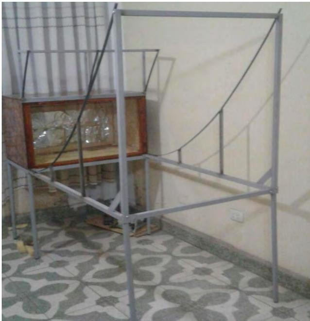
Figura 10. Cámara de cocción: acumulador solar tipo caja revestido con aislante de fibra de vidrio y estructura de los reflectores parabólicos cilíndricos asimétricos
