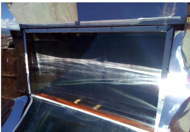
Figura 11. Concentración de los rayos solares sobre el foco lineal en el colector metálico vertical de la cocina solar tipo caja con CPC asimétrico.
