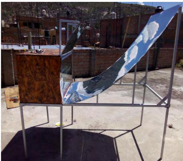
Figura 11. Acabado final de la cocina solar tipo caja con concentrador parabólico compuesto asimétrico.
