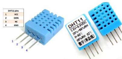
Fig. 3. Sensor de temperatura y humedad DHT11
