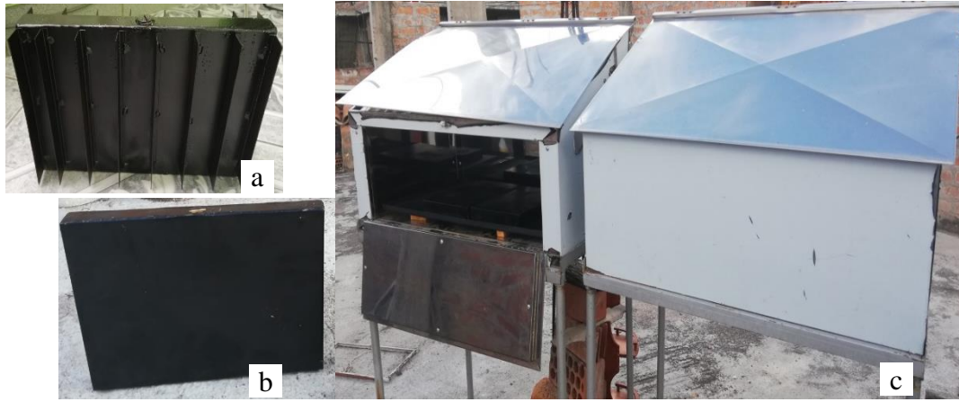
Figura 15. (a) Módulo con PCM con aletas internas-externas (b) Módulo con PCM con aletas internas. (c) Cocinas solares de igual dimensión y comportamiento térmico.
