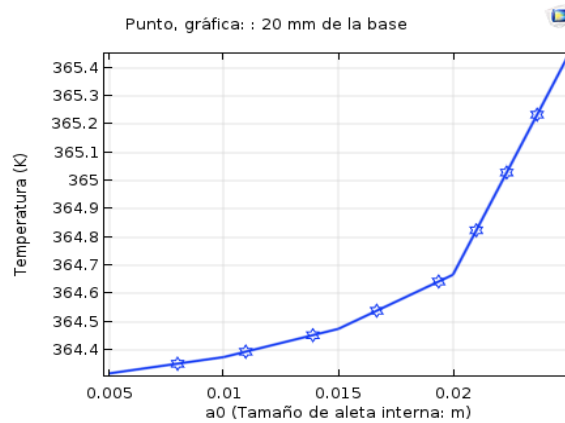
Figura 9. Variación de la temperatura en un punto ubicado en el interior del PCM a 20 mm de la base en razón al tamaño de la altura de la aleta interna.
