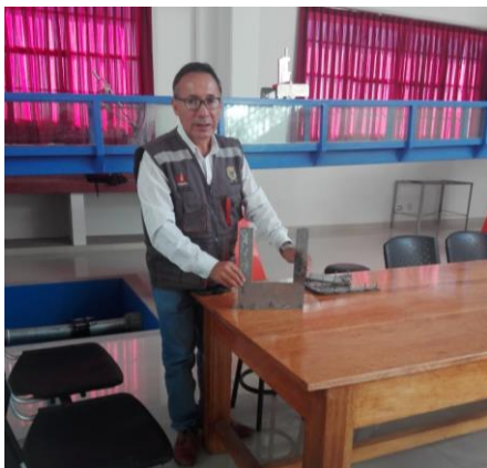
Figura 2. Vertedero rectangular con contracción
