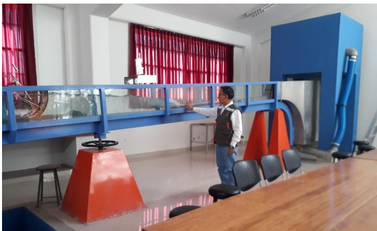
Figura 1: Canal de pendiente variable de sección rectangular
