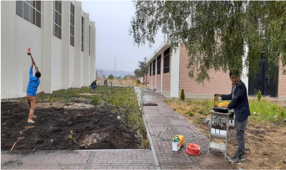
Figura 6.- Proceso de calibración del equipo de refracción sísmica y estimulación de la fuente con presencia del colaborador de la investigación.
