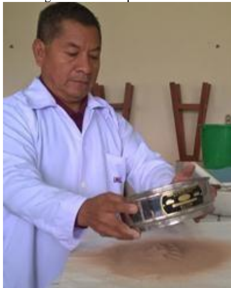
Homogenización del tamaño de partícula de la arcilla roja de Ayacucho.
