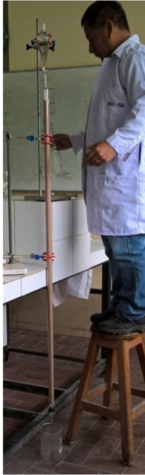
Control del proceso de remoción de arsénico en el reactor de lecho fijo a nivel semipiloto.
