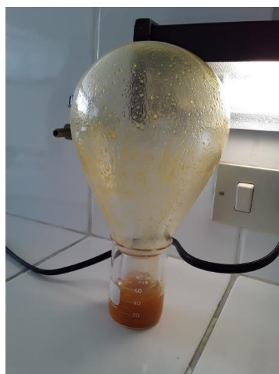
Foto 8. Balón del rotavapor al vacío.
