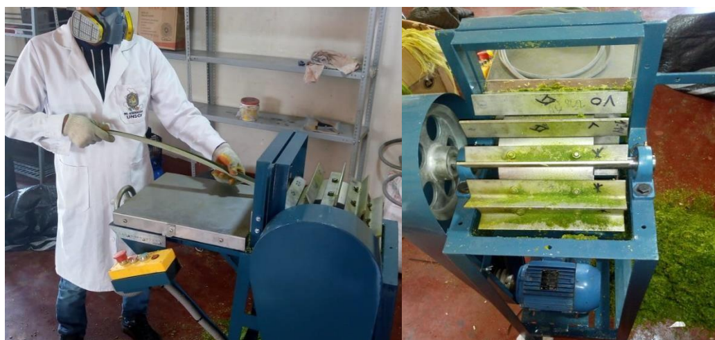
Figura 1. Obtención de fibra de rastrojo de piña con desfibradora mecánica.
