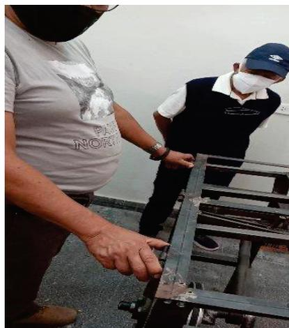
Figura 1 . En la prueba inicial la mesa concentradora tenía un movimiento vertical
