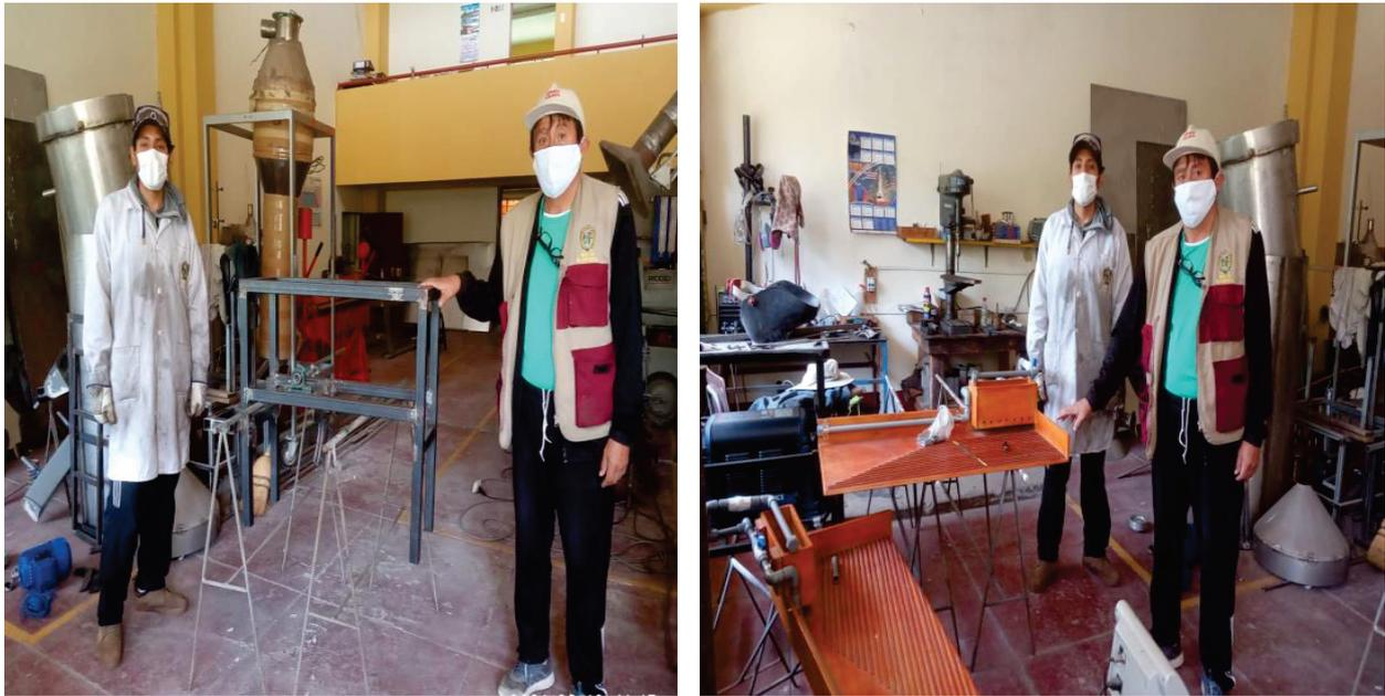
Figura 2. Equipo a ser modificado: (a) izquierda, estructura de la mesa gravimétrica; (b) derecha, tablero superior.
