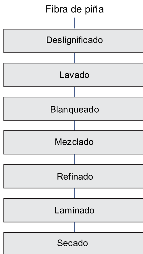
Figura 2. Operaciones para la obtención del material base de los residuos de las fibras de hoja de piña para cuero vegetal.
