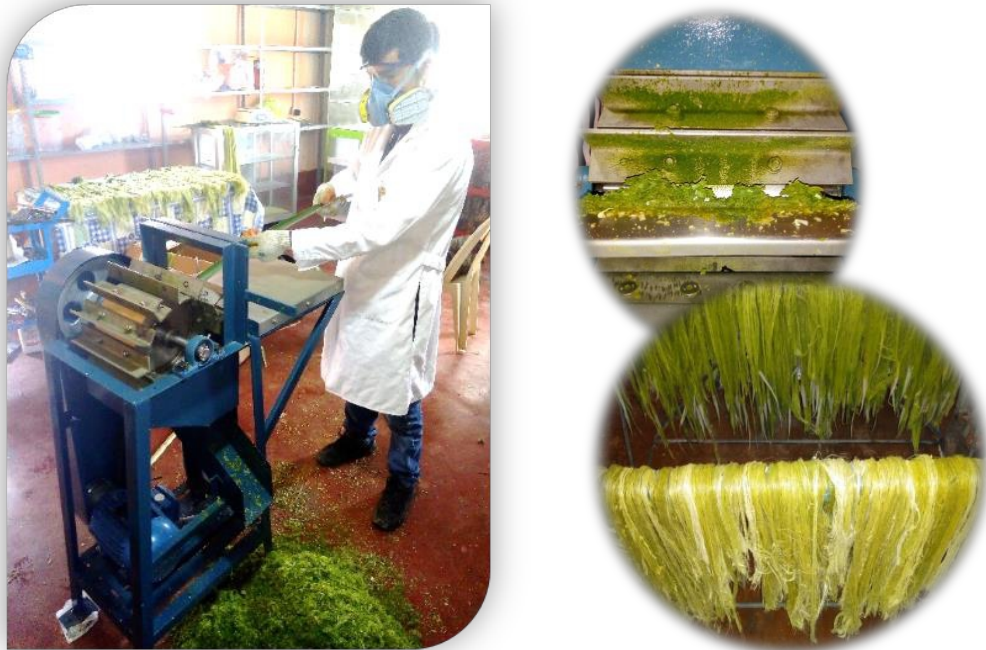
Figura 4. Prototipo desfibrador, apertura de cuchillas y fibra obtenida sin desperdicio.
