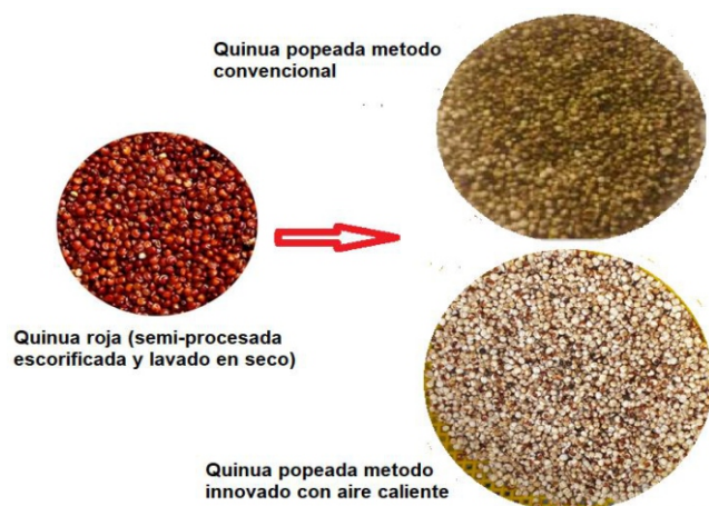
Figura. 7. comparación de popeado de quinua por el método convencional e método innovado.
